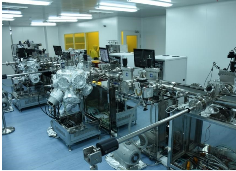
图 3-4 本文用于制备 Nb 超导薄膜的磁控溅射系统。
