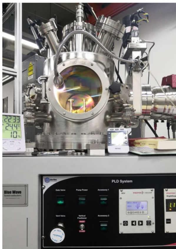
图 3-2 本文用于制备 FeSe 超导薄膜的脉冲激光沉积设备实物图。
