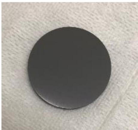
图 5.2  $\text{La}_{2-x}\text{Ce}_x\text{CuO}_4$  靶材。
