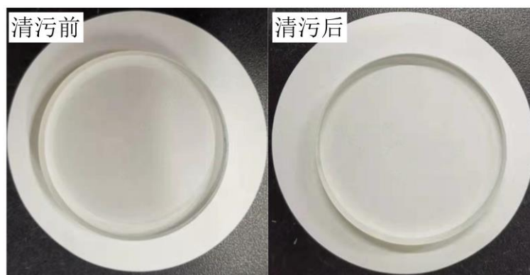
图 2-10 PLD 沉积腔体激光透镜清污前后实物图
