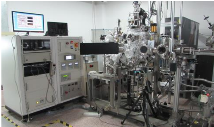
图 4-5 日本 Pascal 公司生产的激光分子束外延设备实物图
