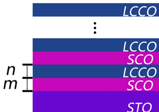
图 5.7: 制备SrCoO 2.5 /LCCO 多层膜的示意图。
