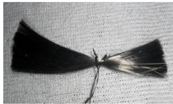
测量样品质量后，将其浸泡在硝酸溶液中仅使铜被溶解。随后测量剩余的Nb-Ti丝和Nb阻隔层的质量。利用初始线材的体积和质量以及丝的质量确定铜-超[体积]比。
