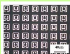
利用优化工艺制备的太拉赫兹超材料
