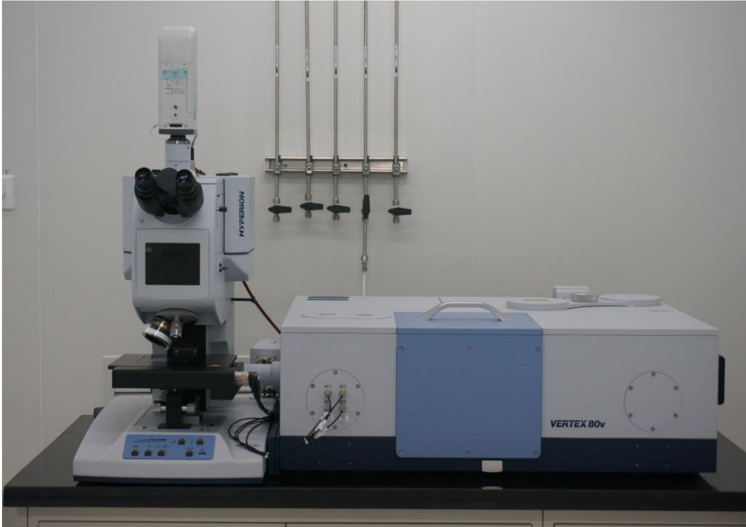
Vertex 80v光谱仪和宏观光路
