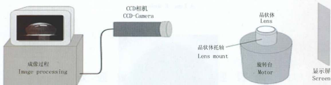
图 3 晶状体弹性评估设备示意图
