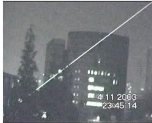
图 1 中国科学院物理研究所利用超短脉冲激光在空气中产生的电离通道
